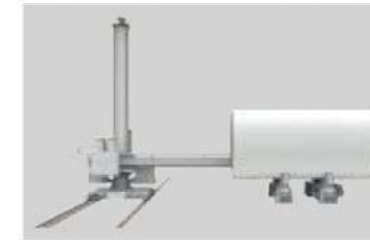
Kolon bom'un ilerleme hareketiyle iç boy kaynağı
