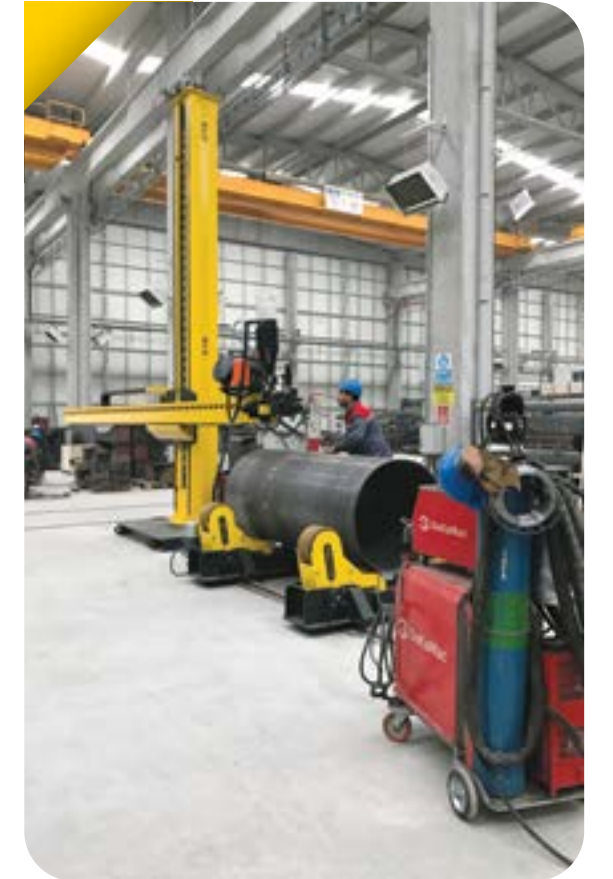
Çift kaynak başlığı ile dış dairesel kaynak (çevirici ile)
