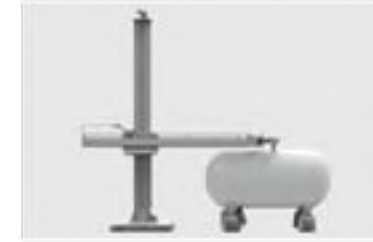
Çift kaynak başlığı ile dış dairesel kaynak (çevirici ile)
